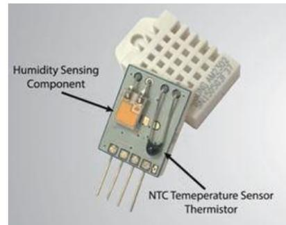
Figure 4: DHT11 Sensor
